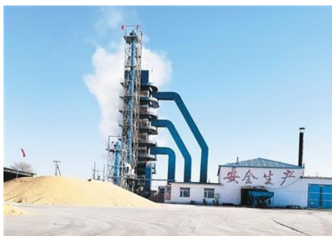
内蒙古自治区赤峰市松山区安庆镇某粮食产后服务中心正在用烘干塔烘干玉米。
