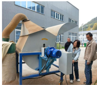
环保型中药材净制撞药机调试现场
