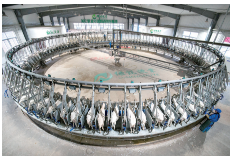
绿能牧业的转盘式挤奶器
